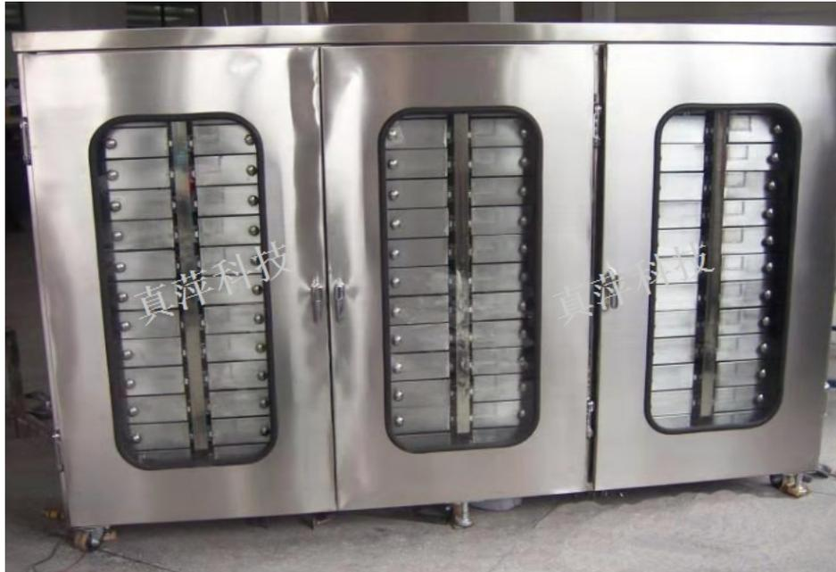
使用高温钟罩炉有特定的操作方法，需按照标准操作规范进行，下面是真萍科技的钟罩炉的使用注意事项。在使用高温钟罩炉时，其升温要缓慢地用逐渐进步电压的方法进行。留意不要超过安全温度，避免焚毁电热丝。将物料放入炉膛时，切勿碰及热电偶，因伸入炉膛内的热电偶热端在高温下易于折断。将金属及其它矿藏放入高温钟罩炉炉内加热时，有必要置于耐高温的瓷坩埚或瓷皿中，或垫以耐火泥板或石棉板，避免与炉膛粘连在一起。不要让高温钟罩炉受潮，以防漏电。气氛炉的重要组成部分。上海中高温气氛炉
